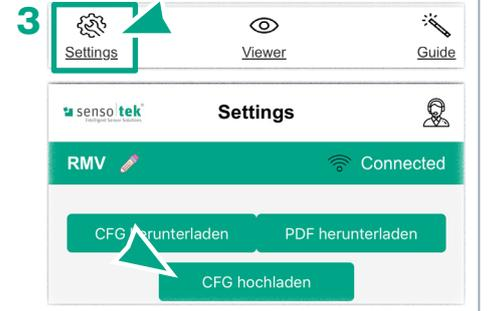
Mehrere Sensoren RMV-D2 mit gleichen Voraussetzungen montieren und konfigurieren → gespeicherte Konfiguration des ersten RMV-D2 auf die anderen Geräte übertragen
