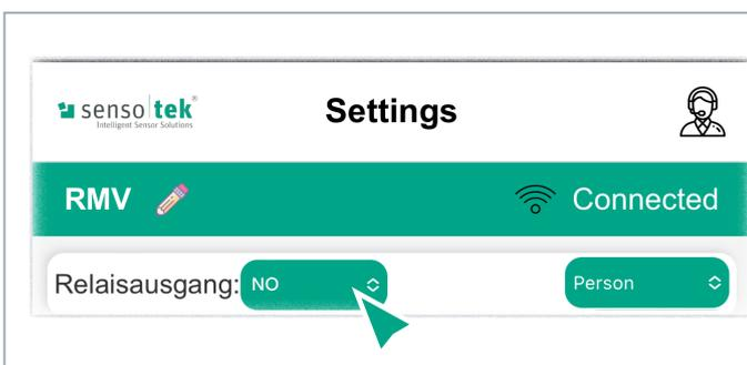
Werkseinstellung → NO/NC, Person/Fahrzeug: Diese Einstellungen können hier geändert werden.
