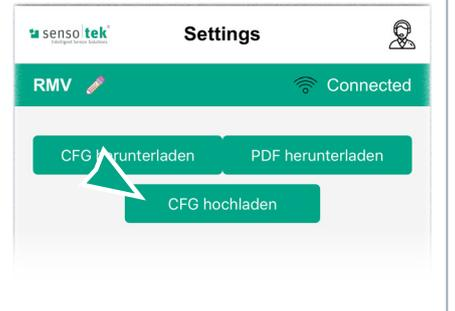
Liegt bereits ein Konfigurationsprofil vor, kann dieses direkt hochgeladen werden:
